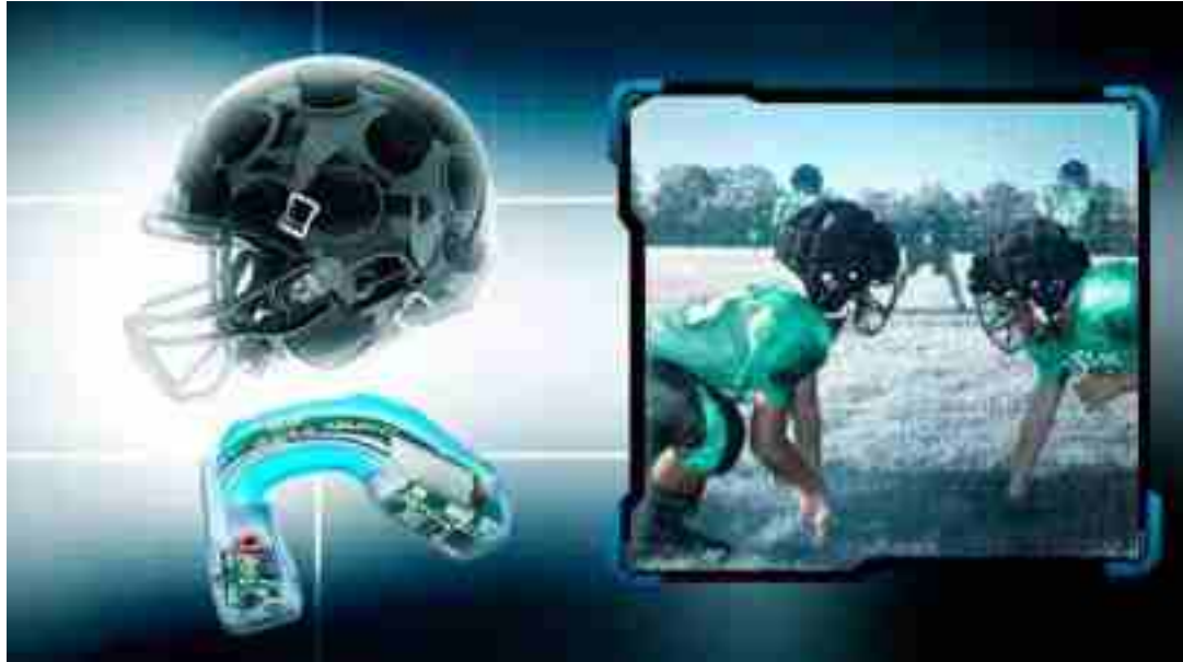
그림 3 NFL 선수 충격 측정 웨어러블 디바이스(마우스 피스 및 헬멧)
