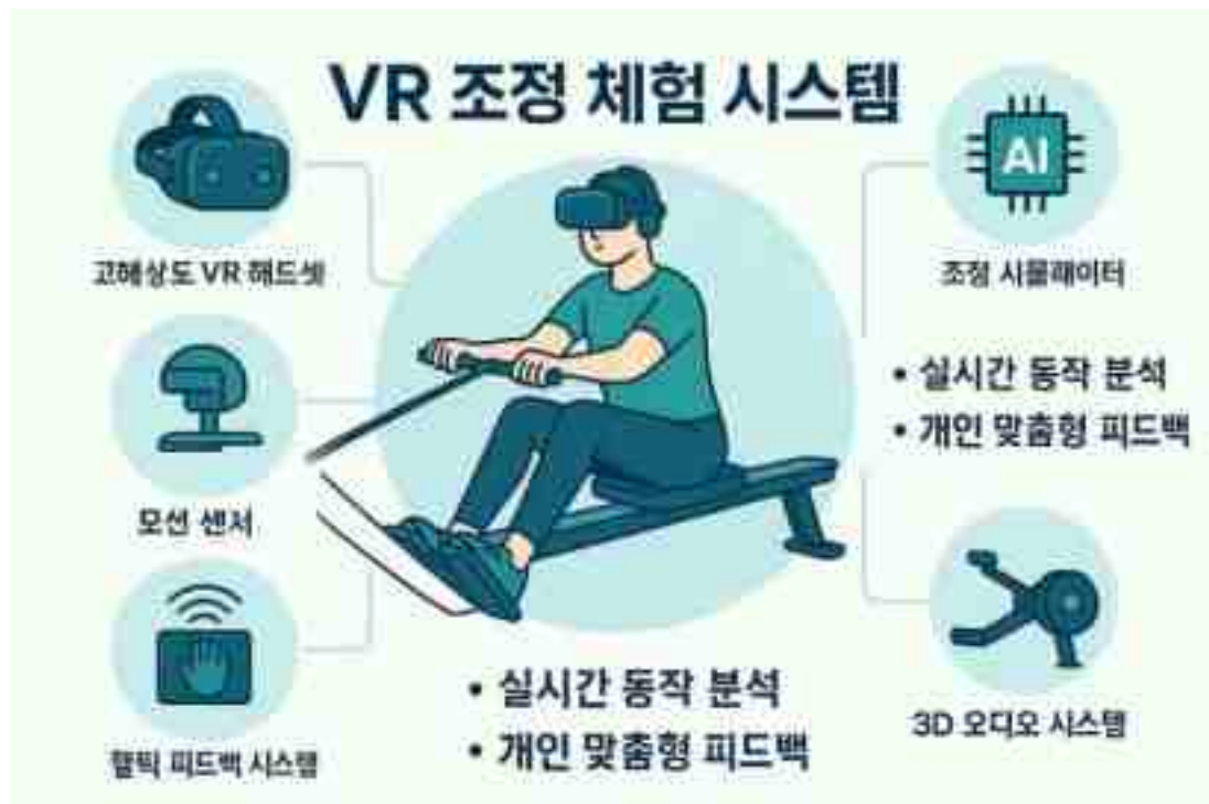
그림 19 VR 조정체험시스템 구성 요소
